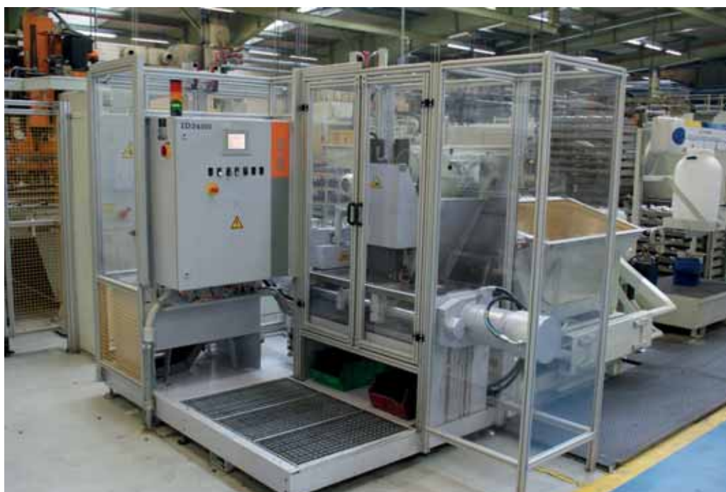
La bricchettatrice in uso presso la GKN Driveline di Brunico (Bolzano).
