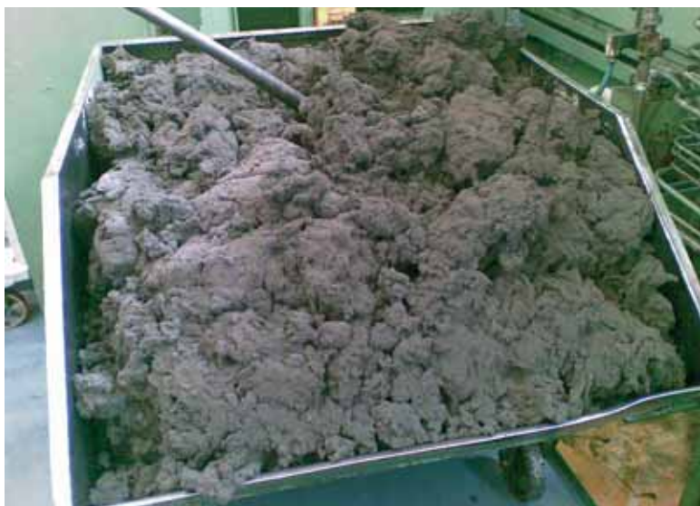
A sinistra i fanghi di rettifica, a destra i bricchetti che vengono rivenduti come truciolo metallico.
