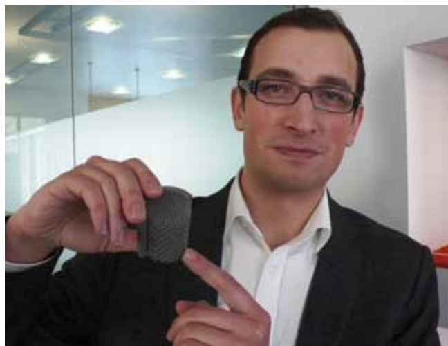
"La fattibilità del processo per produrre componenti con la tecnica del laser generativo è chiaramente superiore a quella del casting", afferma Bechmann mostrando un complesso pezzo strutturale realizzato in titanio
