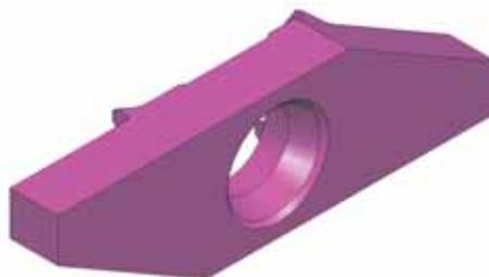
In risposta a questa difficoltà, la Società Bimu ha realizzato una placchetta sinterizzata in un metallo duro con una maggiore resistenza all'usura. Abbinato ad un rivestimento di ultima generazione (BI42), questa placchetta offre condizioni ottimali per la lavorazione di materiali quali il 316L, 4C27A, CuBe così come degli acciai inox temperabili in generale. Questa placchetta è stata studiata sulla base di uno sbizzo del programma 400-line con sistema di fissaggio X-Centering.
