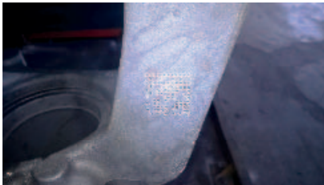
La marcatura dev'essere leggibile anche dopo diverse lavorazioni e processi chimici
