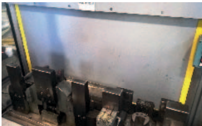
L'attrezzatura pronta per accogliere il nuovo grezzo da marcare e lavorare
