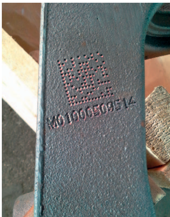
Un problema nella lettura del codice Data Matrix può fermare l'intero processo produttivo: per questo è fondamentale che risulti sempre perfettamente leggibile
