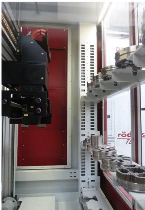
Il sistema di carico/scarico automatico movimentato fino a 36 pallet portapezzo
