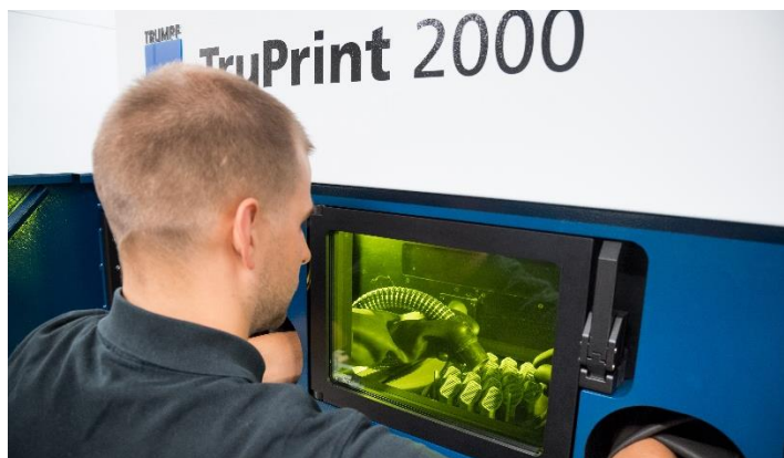
I componenti nella TruPrint 2000 sono trattati in un'atmosfera completamente inerte e senza che l'operatore entri in contatto con la polvere.
