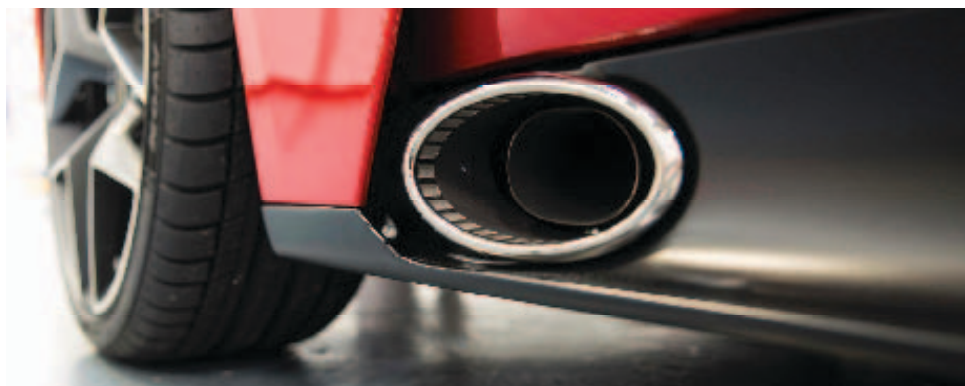
Dettaglio del terminale di scarico della TVR Griffith realizzato con finitura a contrasto "lucida vs opaca"
