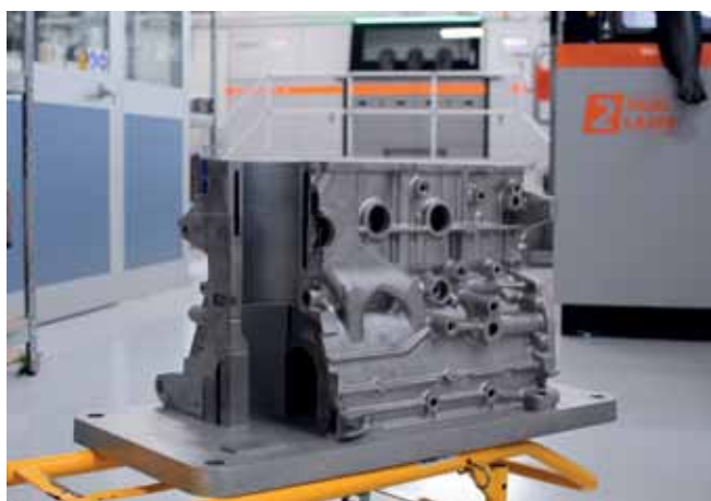
Un banco motore realizzato in Additive Manufacturing
