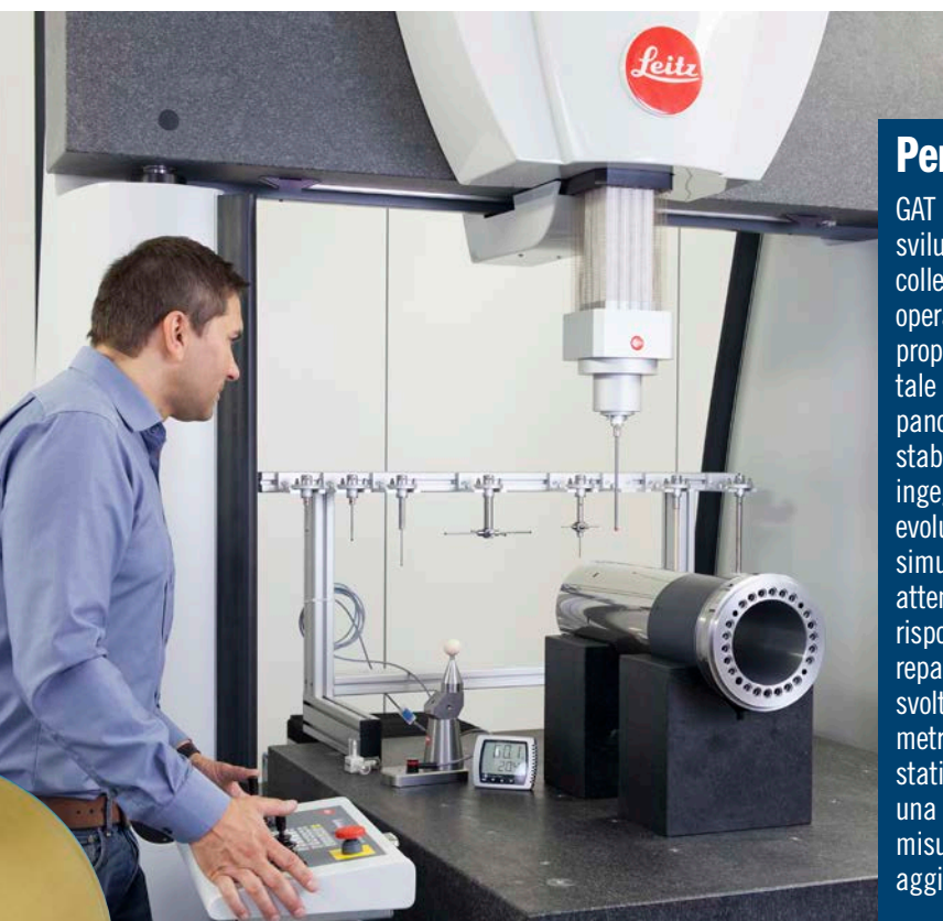
Controllo dei componenti su una macchina di misura a coordinate all'interno dello stabilimento GAT di Geisenheim (Germania).
