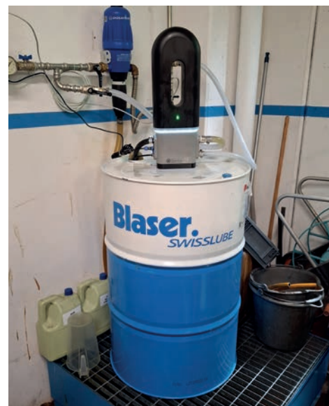
Liquidtool rabbocca automaticamente ogni serbatoio del lubrorefrigerante con la concentrazione corretta
