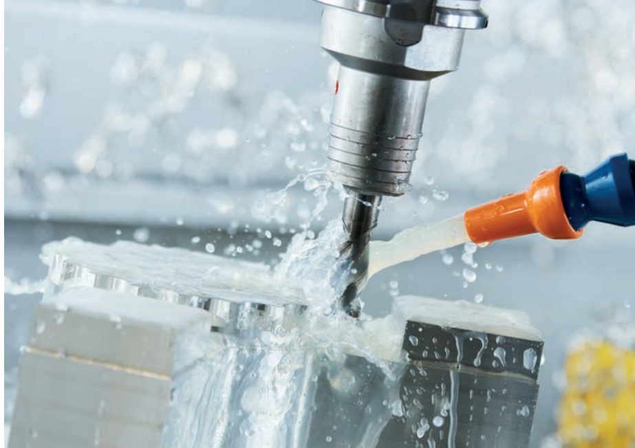
Il lubrorefrigerante come "Liquid Tool": un componente attivo del processo, capace di influenzare qualità superficiale, durata utensile, stabilità e costo finale del pezzo.
