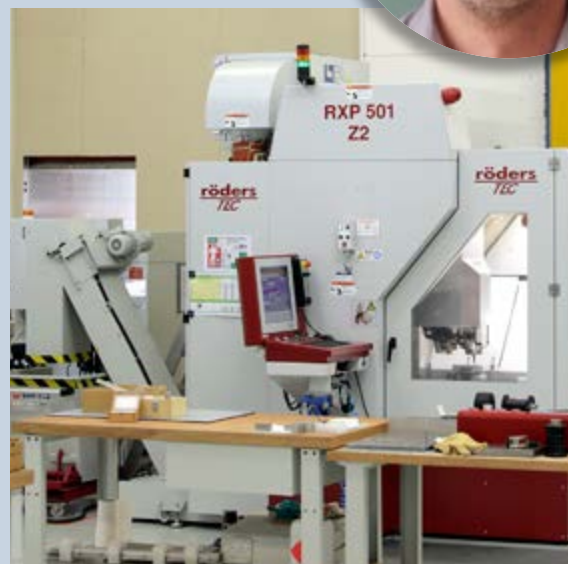
La fresatrice ad alta velocità serie RXP Röders, scelta da iGuzzini, fornita e installata da Ridix, è pensata e studiata per eseguire cicli di lavorazioni anche molto lunghi per ottenere ottiche ultra-precise e super-lucide (ph. Archivio iGuzzini)
